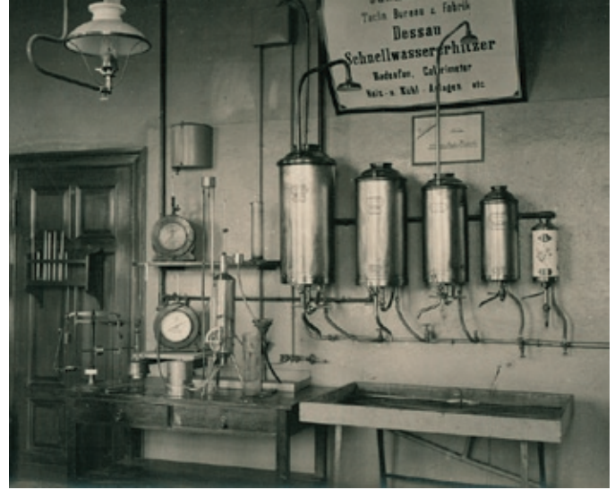
Der Prüfstand für Gasbadeöfen in der ehemaligen Warmwasser-Apparatefabrik Junkers & Co in Dessau | The test rig for gas boilers in the former hot water appliances factory Junkers & Co. in Dessau.
